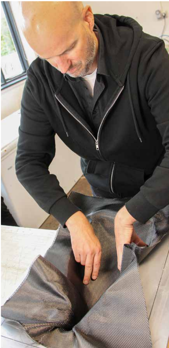
Eine unlösbare Aufgabe (links): In dieser Gussform werden die raumakustisch wirksamen „Hauben“ der Fibonacci-Lautsprecher gebacken und in Kunstharz vergossen. An einem gewöhnlichen Carbondgewebe habe ich mir zur Erheiterung aller Anwesenden sprichwörtlichen die Zähne ausgebissen ... Rechts lächelt er schon wieder: Ein Spezialgewebe, das Wilson Benesch gemeinsam mit dem AMRC entwickelte, gleitet nahezu von selbst und faltenfrei in die Form. Mein Dank an Olaf Sturm für die hübschen Fotos.
